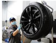
ドイツ製超音波タイヤ・ホイール洗浄機を導入しています。通常の洗車では落とせないホイールの裏側やしつこい汚れを超音波と専用洗浄剤でキレイに落とします。
